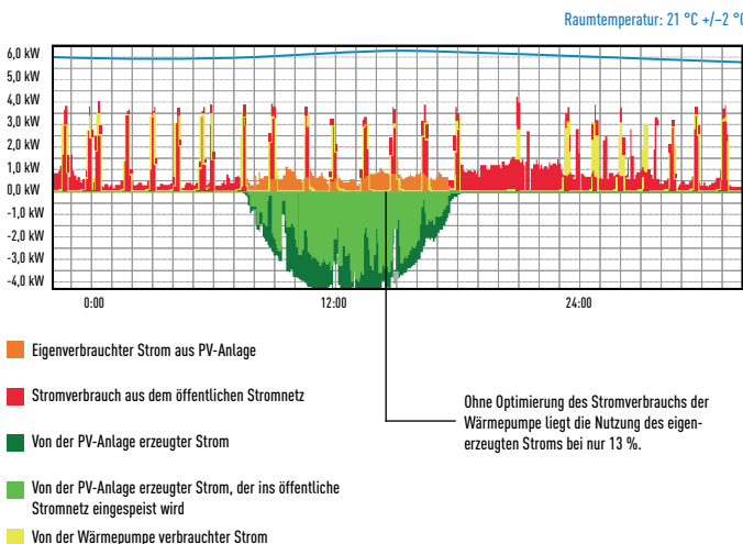
Typisches Profil für Stromverbrauch und -erzeugung ohne Aquarea-Regelung
